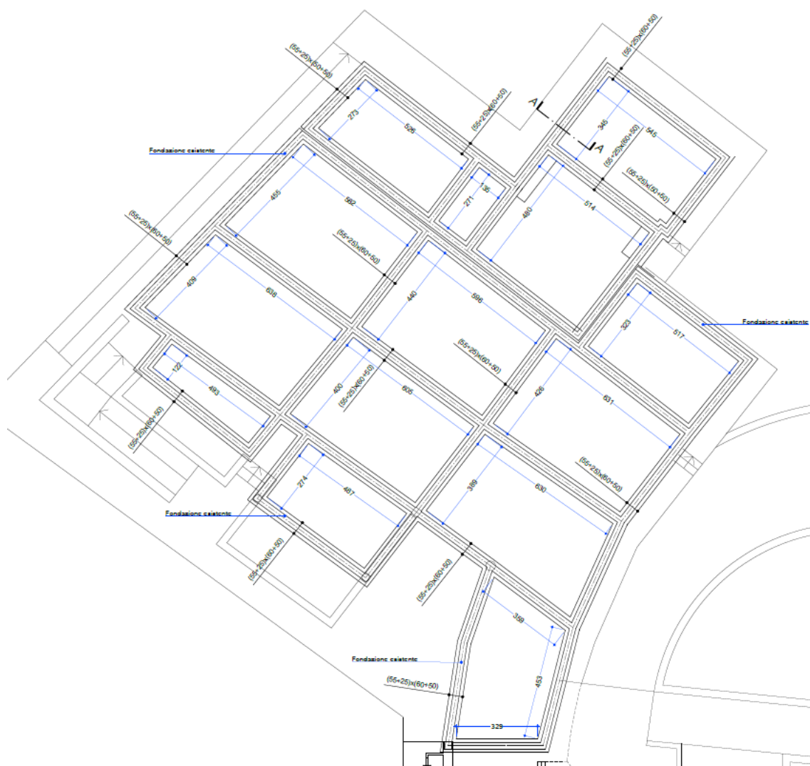
Figura 4: Inquadramento nuove travi di fondazione
